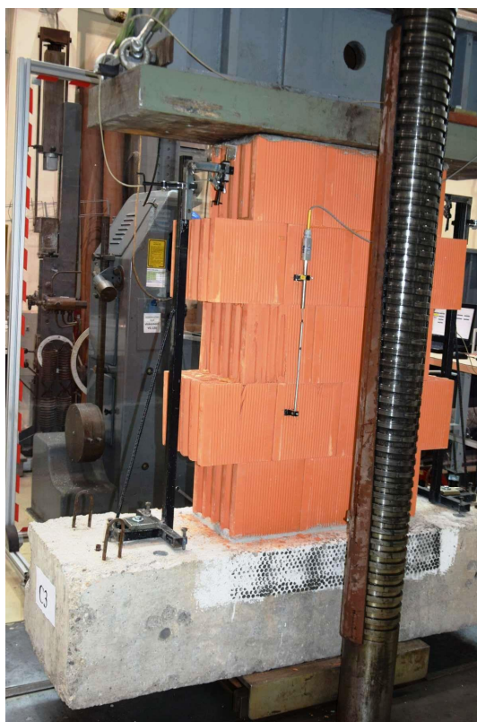
Slika A15: Preizkušalec C3 po poružitvi - sprednja stran z bolj poškodovane leve strani.
