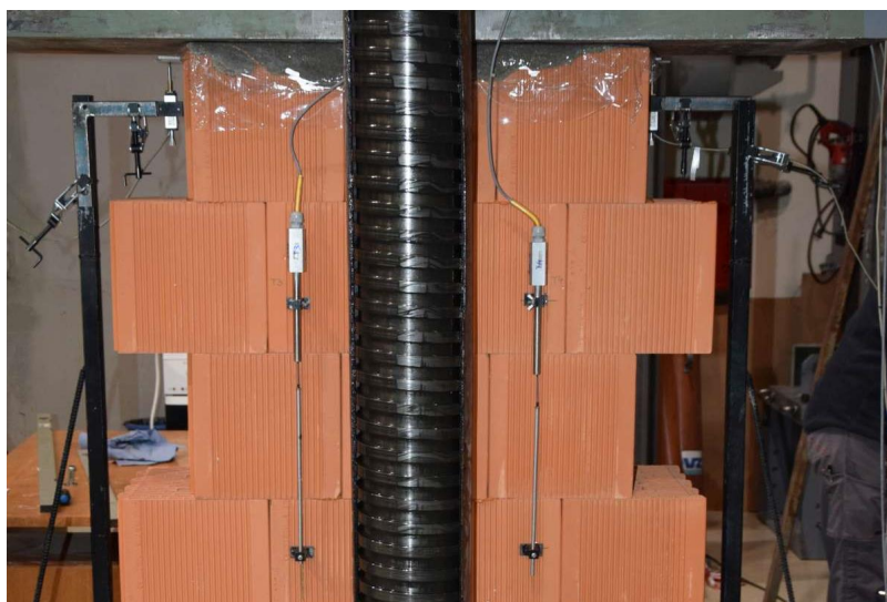
Slika A3: Izravnalna masa iz cementne malte na vrhu zidu.
