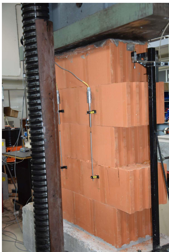
Slika A14: Preizkušalec C3 po poružitvi - zadnja stran.
