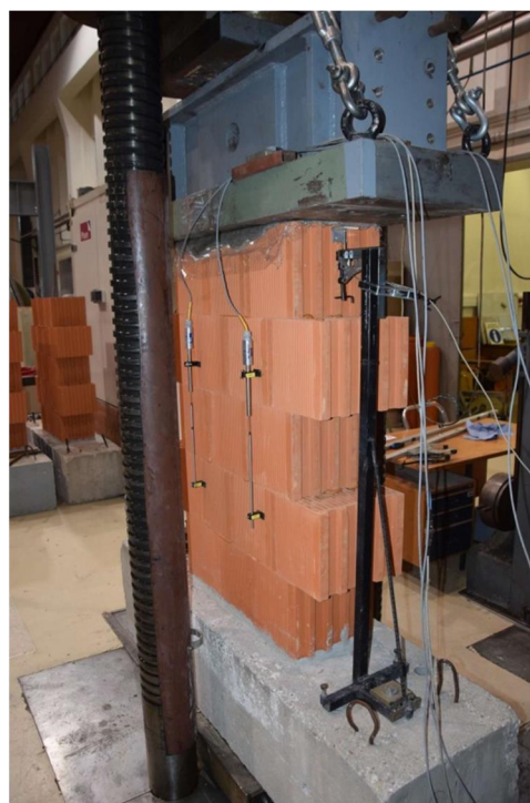
Slika 2: Preizkušanec med tlačnim preskusom.
