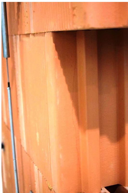
Slika A13: Prva razpoka pri sili 165 kN - desna stran, tretja vrsta.
