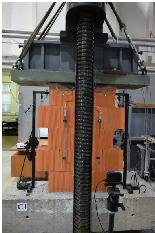
Slika A4: Preizkušajec C1 na začetku preskusa - sprednja stran. Leva in desna stran preizkušajca se nanašata na pogled s sprednje strani.
