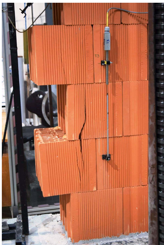
Slika A10: Razpoke pred poružitvijo pri sili 780 kN - sprednja stran.
